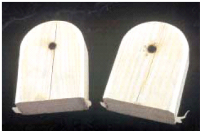
Los bloques de madera apoyan la armadura. La madera carbonizada crea portes "de carbón" para el eje para girar en.
