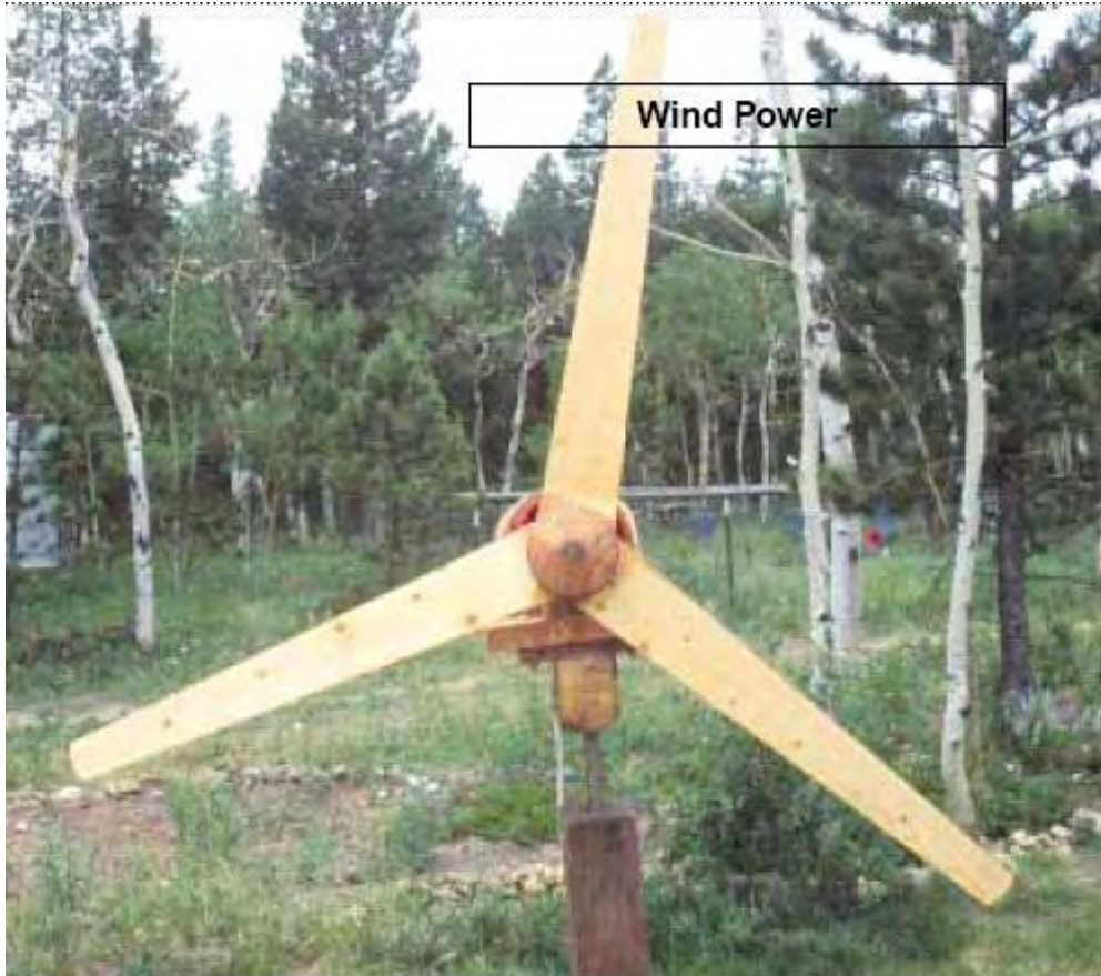
La "Madera 103" Generador de Viento tiene tres láminas esculpidas por mano dar de 610 mm de largo a un área barrida de 1.17 metros cuadrados
