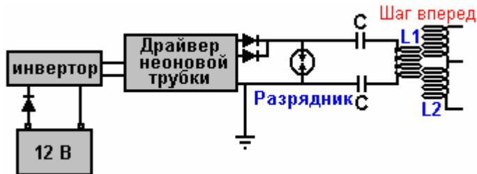
насколько я понимаю, это было бы вполне жизнеспособное соглашение. Вы помните, что Тесла, который всегда очень высоко отзыается об энергии, выделяемой очень резким разрядом, создаваемым искрой, показывает источник высокого напряжения, питающий конденсатор энергией, проходящей через искровой разрядник к первичной обмотке трансформатора:
