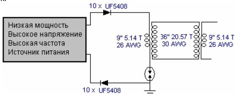
Здесь идентичный трансформатор, намотанный точно таким же образом используется в обратном порядке для запуска последовательности понижения напряжения. Соотношение длин проводов поддерживается для поддержания резонанса обмоток трансформатора друг с другом.
