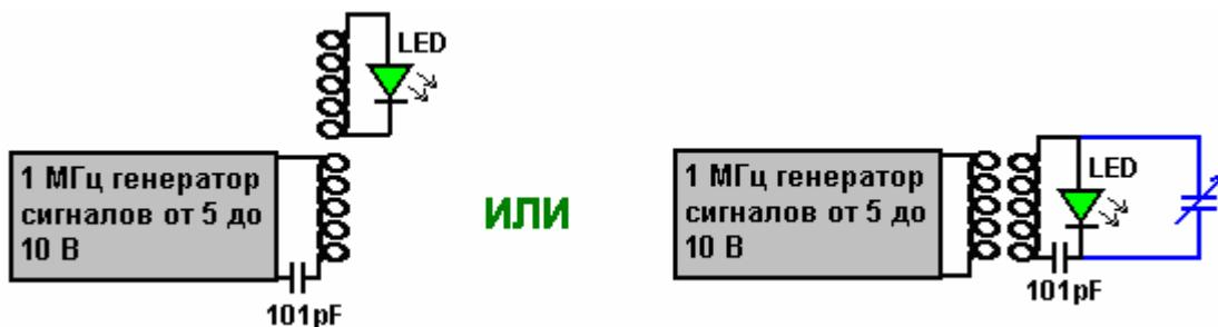
Прежде чем купить комплект, не упоминается, что для его использования теперь вам понадобится генератор сигналов, способный генерировать сигнал 10 В на частоте 1 МГц. Катушка имеет сопротивление постоянному току всего 1,9 Ом, но при резонансной частоте 1 МГц необходимая мощность привода довольно низкая.
