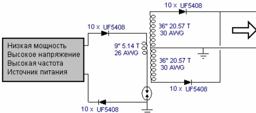
Здесь дополнительные высоковольтные диоды позволяют соединять две противофазные обмотки друг с другом.
