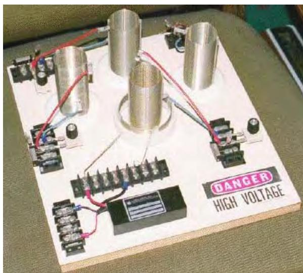
Катушка в центре платы представляет собой передатчик энергии, изготовленный из катушки Тесла, изготовленной из двух готовых катушек Barker & Williamson. Еще три из внутренней катушки также используются в качестве приемников энергии. Внешняя катушка большего диаметра находится в нескольких оборотах от одной из их стандартных катушек и организована таким образом, что длина провода катушки составляет одну четверть длины провода внутренней катушки («L2»).
