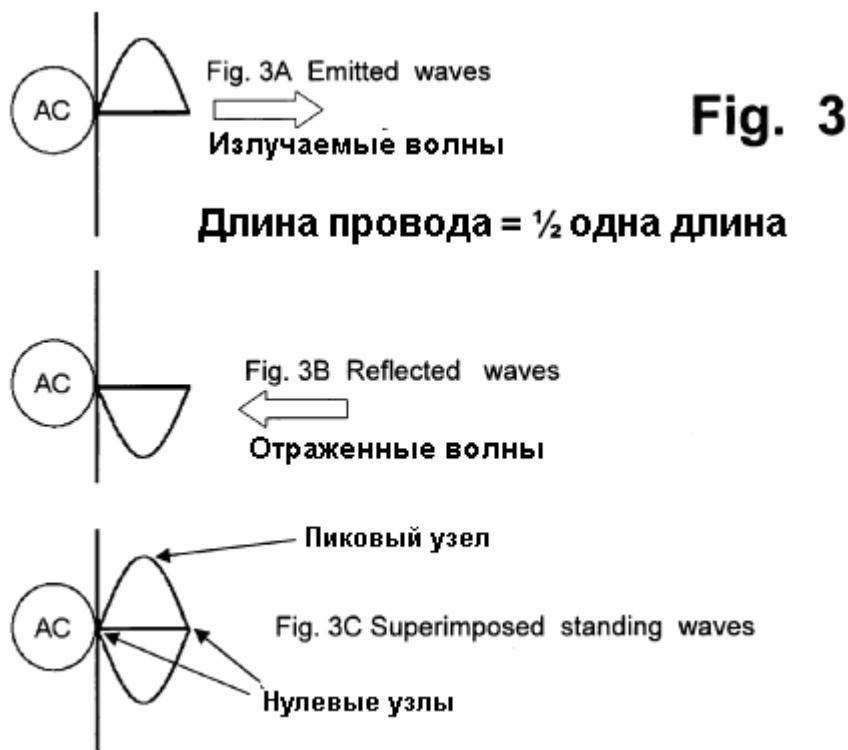
Переходя к ещё более коротким проводам, тот же принцип применим и к любому проводу с длиной, равной половине длины волны переменного напряжения. Как показано на Fig.3 (которая
