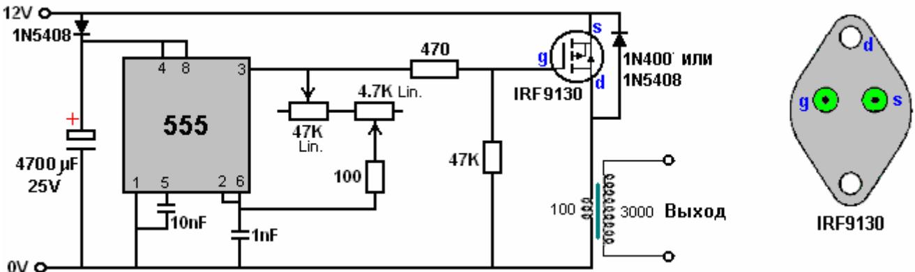
Одним из преимуществ этой схемы является то, что выходной трансформатор работает на частоте, установленной таймером 555 и на эту частоту не влияет ни количество витков в первичной обмотке, ни индуктивность, диаметр провода или что-либо еще, связанное с катушкой. Хотя эта схема показывает довольно дорогой транзистор IRF9130, я ожидаю, что другие полевые транзисторы с каналом Р-типа будут работать удовлетворительно в этой схеме. Транзистор IRF9130 выглядит следующим образом:
