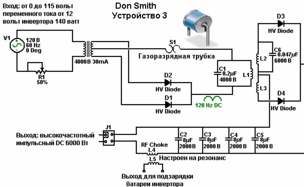
Трансформатор 4000 В 30 мА, показанный на этой принципиальной схеме, может использовать ферритовый сердечник из модуля драйвера с неоновой трубкой, который повышает напряжение, но не повышает частоту, поскольку она чётко обозначена при импульсном постоянном напряжении 120 Гц. Вы заметите, что эта принципиальная схема нарисована с плюсом, показанным ниже минуса (что наиболее необычно).
