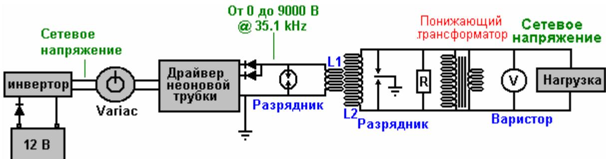
Эта упрощенная схема устраняет необходимость в дорогих конденсаторах и ограничения их номинальных напряжений, а также необходимость электронного управления выходной частотой. Длина провода в витках катушки "L2" по прежнему должна быть ровно в четыре раза больше длины провода витков в катушке "L1", но есть только один компонент, который необходимо
