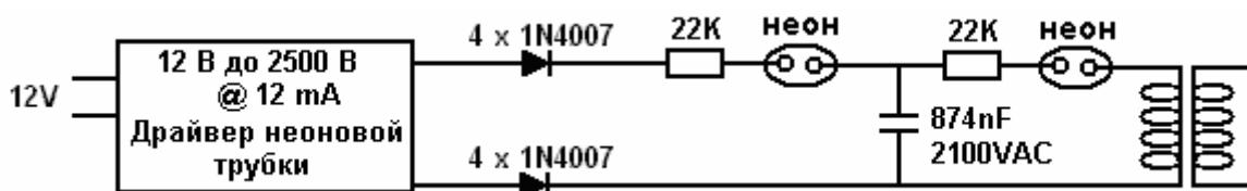
Здесь простой модуль трансформатора для неоновых ламп, который не имеет заземления, используется для создания напряжения 2,5 кВ с частотой 25 кГц и максимальной выходной токовой емкостью 12 мА. Нет никаких трудностей в создании эквивалента этому блоку питания. Два выхода модуля преобразуются в постоянный ток цепочкой из четырех последовательно соединенных диодов 1N4007 на каждом из двух выходов (каждая цепь находится внутри пластиковой трубы для изоляции).
