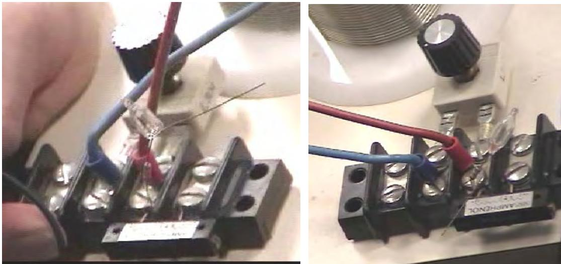
Поскольку в изготовленных катушках имеются очень небольшие различия, каждая из них настроена на точную частоту передатчика, а миниатюрный неон используется, чтобы показать, когда настройка была установлена правильно.
