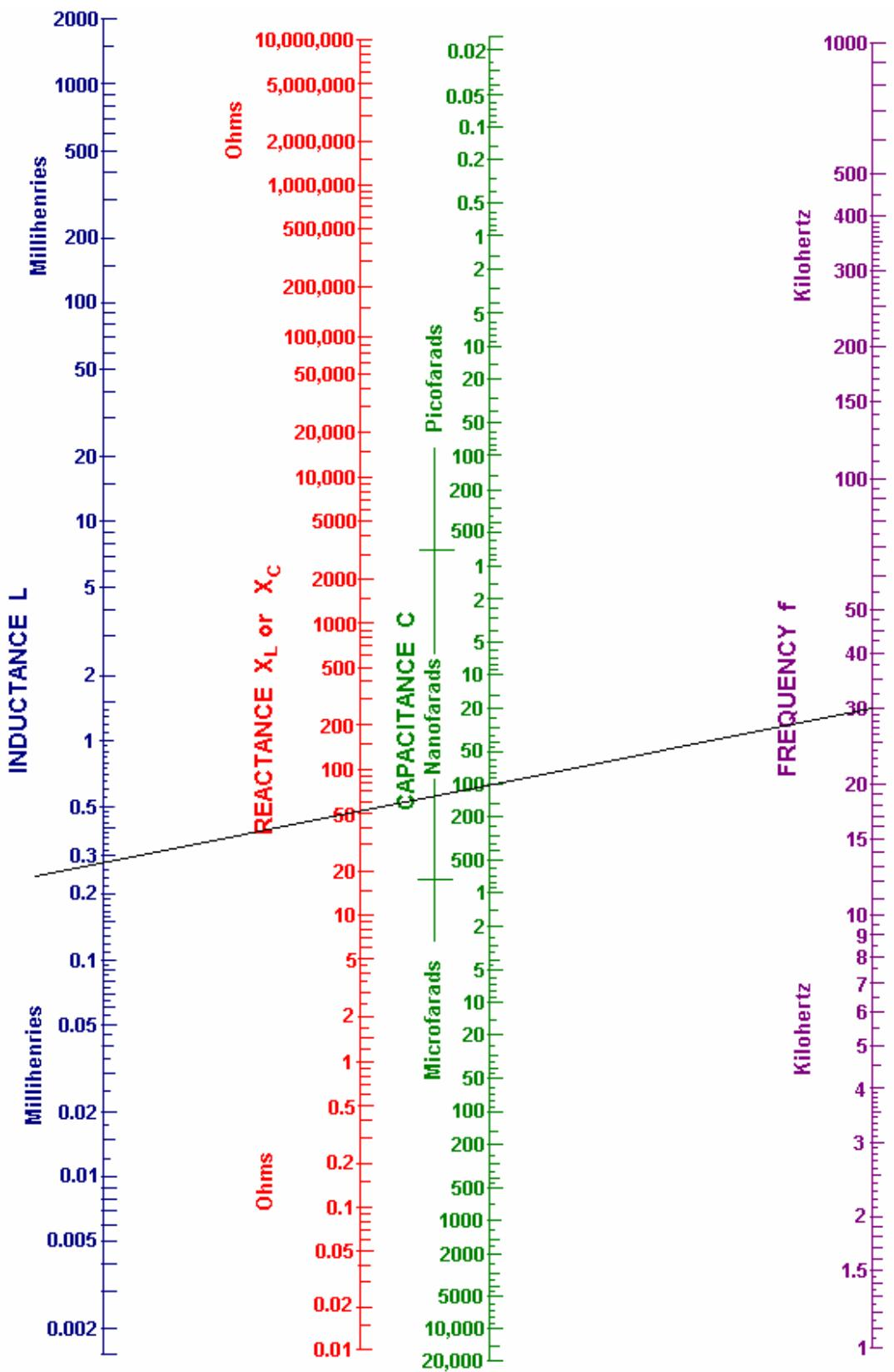
Нарисуйте прямую линию от частоты 30 кГц (фиолетовая линия) до значения конденсатора 100 нанофарад и продолжайте линию до синей линии индуктивности, как показано выше.
