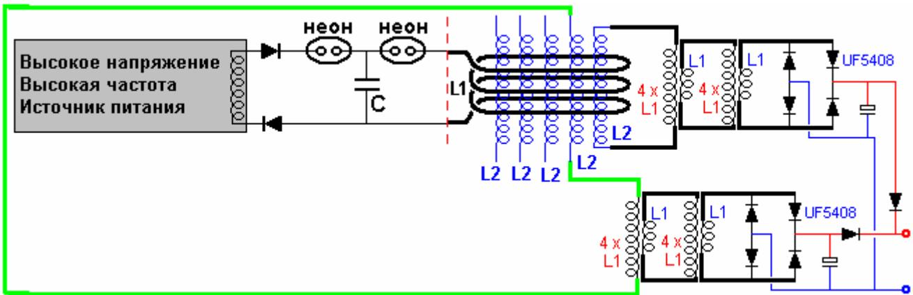
Где показаны две катушки L2, соединенные вместе для увеличения выходной мощности. Эта схема использует недорогие низковольтные компоненты для выходных каскадов и нет очевидных ограничений на количество выходной мощности, которое может быть обеспечено. Поскольку цепь работает с высокой частотой повсеместно, нет особой необходимости в том, чтобы физически размещать дополнительные катушки L2 внутри катушки L1:
