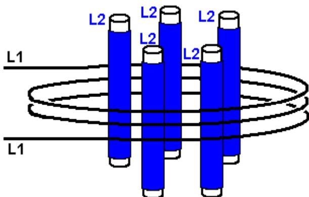
Однако это устройство может иметь преимущество в том, что длина провода катушки L1 больше, что в свою очередь увеличивает длину провода каждой катушки L2 (в четыре раза больше). Это даёт большую гибкость при планировании отношения витков трансформатора L1 / L2. Повышение или понижение напряжения этого трансформатора происходит в соотношении витков, несмотря на то, что это не индуктивная связь и поэтому стандартная технология трансформатора не применяется.
