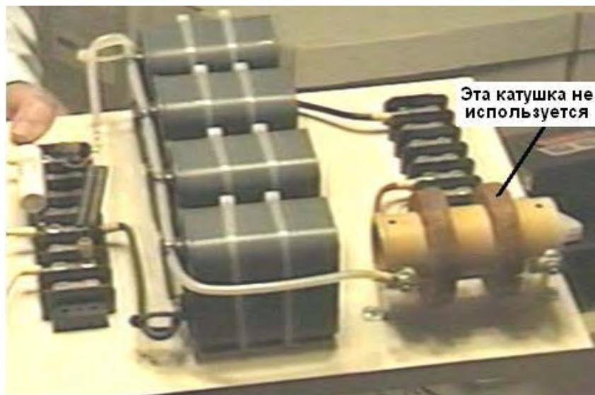
Выходной ток течёт через левую обмотку на коричневом цилиндрическом устройстве, и когда была сделана фотография, правая обмотка больше не использовалась. Ранее он использовался для подачи энергии на зарядку батареи путем выпрямления электрической мощности в катушке, вызванной флюктуирующими магнитным полем, вызванным пульсирующим током, протекающим через левую обмотку, как показано здесь:
