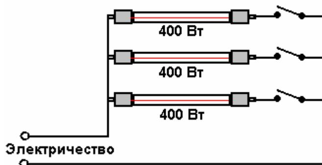
Вы можете изменить проводку внутри нагревателя, чтобы все три галогенные лампы были соединены в цепь. Поскольку провода, соединяющие лампы, снабжены нажимными «лопастными» разъёмами, что позволяет их легко изготовить и легко заменить галогенную лампу, это часто можно сделать без пайки. Новое расположение такое:
