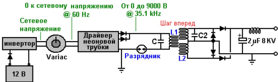
Он комментирует: «Диоды выходящие из драйвера неоновой трубы, возможно придется поменять местами, так как мы хотим собрать отрицательную полярность. Затем искровой разрядник будет работать при инверсии окружающей среды и искра будет выглядеть и звучать совершенно иначе с гораздо более быстрой трещиной и производя очень мало тепла и даже возможно может покрыться инеем.
