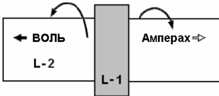
Предполагается, что большую и более эффективную выходную мощность можно получить, разделив катушку L2 под положением катушки L1, намотав вторую часть L2 в противоположном направлении и заземлив соединение двух обмоток L2. Дон не считает необходимым менять направление намотки. В результате получается обмотка L2, которая в два раза длиннее, чем раньше и расположена вот так:
