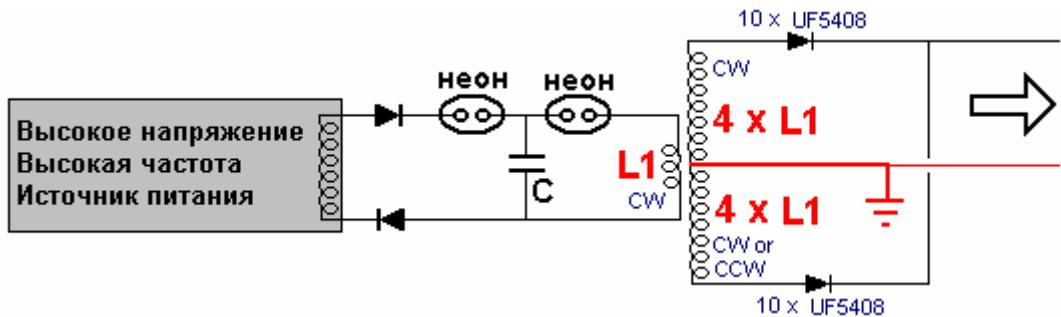
Имейте в виду, есть ещё один фактор, который следует учитывать при выборе наиболее удобной длины провода для L1 и это количество витков в катушке L1. Чем больше соотношение между витками в L1 и витками в L2, тем выше повышение напряжения, создаваемое трансформатором L1 / L2 и помните, что длина L2 фиксирована относительно длины L1.
