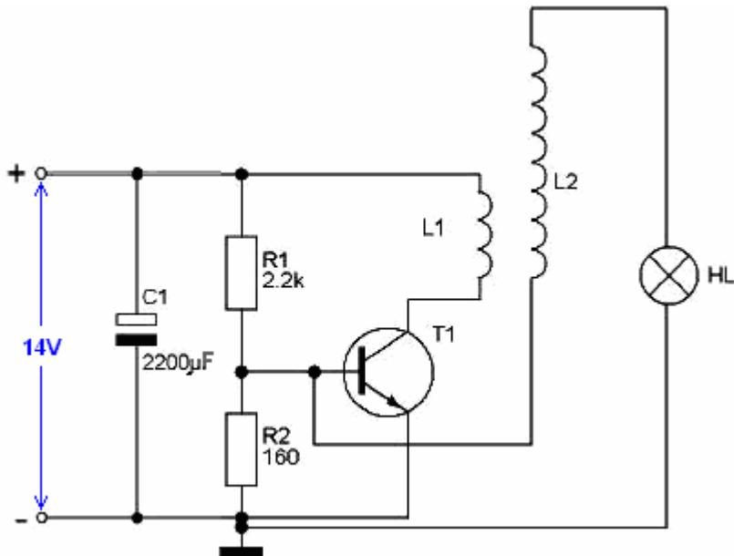
**Fig. 3.** Схема эксперимента по определению активной выходной мощности катушки L2
