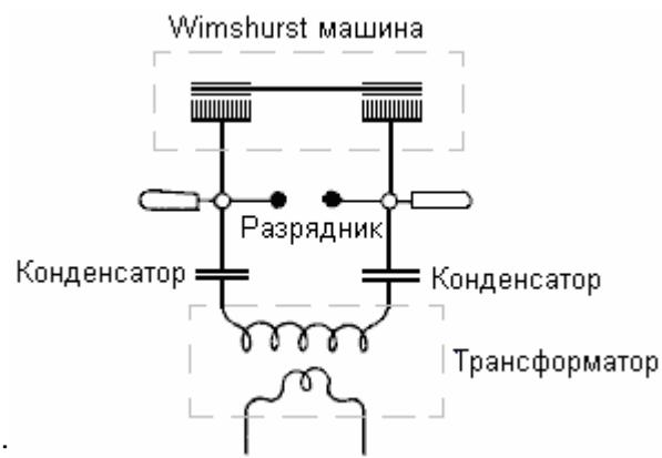
Здесь выходной сигнал машины Вимшерста хранится в двух высоковольтных конденсаторах (лейденских банках), в результате чего на этих конденсаторах создается очень высокое напряжение. Когда напряжение достаточно высокое, искра перепрыгивает через искровой разрядник, вызывая значительный всплеск тока через первичную обмотку трансформатора, который в его случае является понижающим трансформатором, поскольку он нацелен на получение более низкого выходного напряжения. Схема Дона почти идентична:
