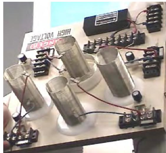
Короткая наружная катушка "L1" удерживается в поднятом положении секцией белой пластиковой трубы, чтобы правильно расположить её относительно вторичной катушки меньшего диаметра "L2".
