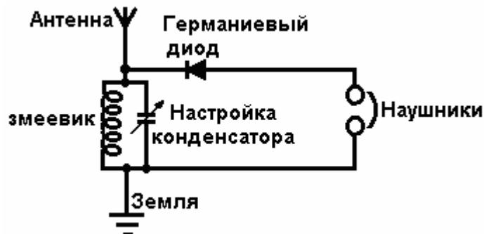
В то время как на приведённой выше схеме обозначено «Настроочный конденсатор», это на самом деле вводит в заблуждение. Да, вы настраиваете радиоприемник регулируя настройку
