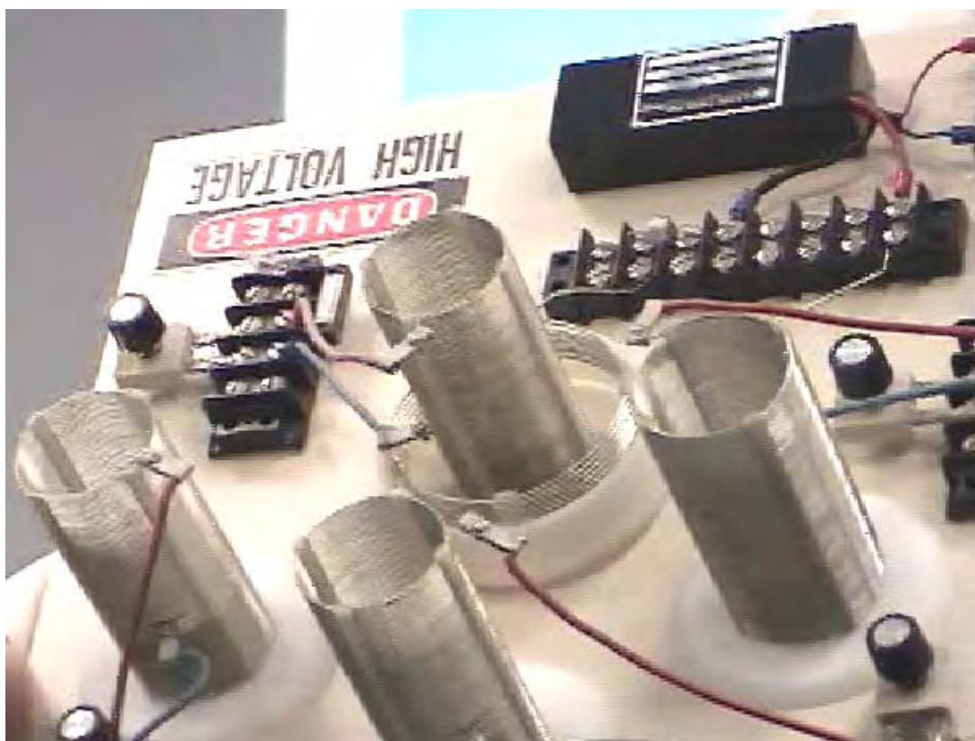
Вторичные катушки конструируются с использованием обычного метода Баркера и Уильямсона (Barker & Williamson's), в котором используются щелевые полосы для удержания витков медной лужёной проволоки на месте.
