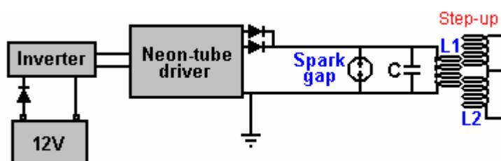
Здесь высокое напряжение исходит от батареи / инвертора / драйвера неоновой трубы / выпрямителей, а не от машины Вимшерста с механическим приводом. Он имеет такое же нарастание напряжения в конденсаторе с искровым разрядником на конденсаторе. Искровой разрядник сработает, когда напряжение конденсатора достигнет заданного уровня. Единственное отличие заключается в расположении конденсатора, который если он точно соответствует расположению Германа, будет выглядеть так:
