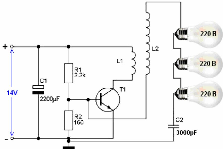
Другой возможностью было бы взять обычный дешёвый галогенный нагреватель и подключить его так, чтобы три 400-ваттные лампы стояли последовательно, а не параллельно:
