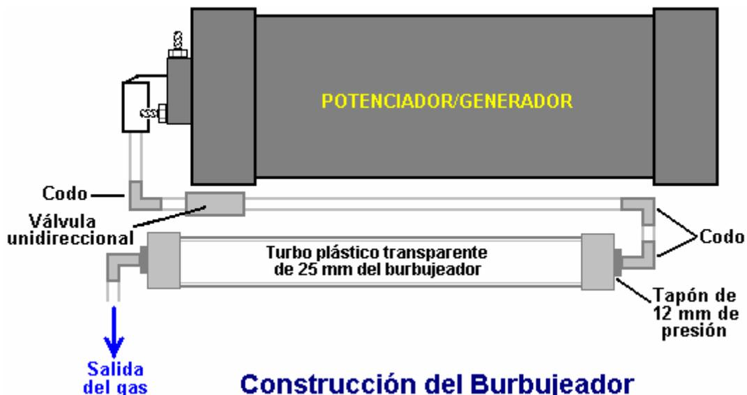
Los codos de  $\frac{1}{2}$ " de los extremos del tubo de 1" del burbujeador tienen sus roscas cubiertas con silicona antes de ser colocados en su lugar. Esto permite que actúen como aliviadores de presión en el caso improbable de que el gas se encienda. Se trata tan solo de otra medida de seguridad que de ninguna manera sobra.
