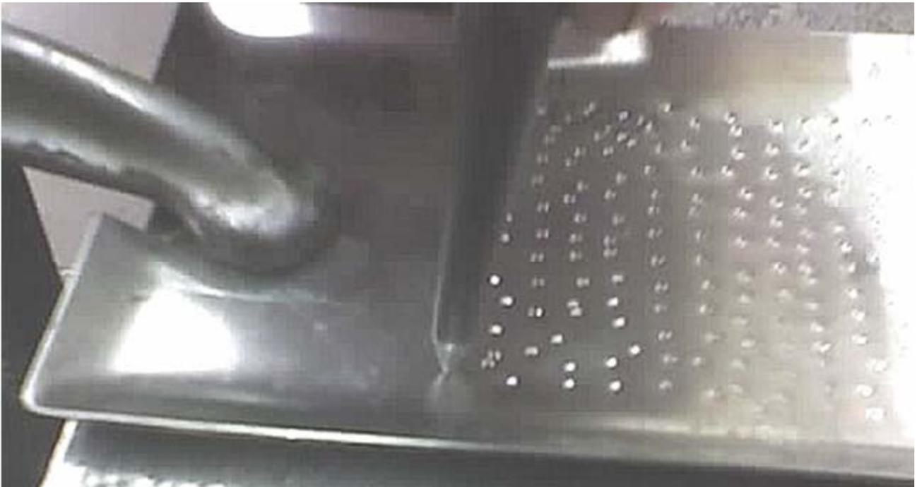
La preparación de las placas es muy importante. Luego del punzonado, las placas deben ser sometidas a granallado ó “sandblasteado” (sand blasting). Si no dispone del equipo, llévelas al punto más conveniente ya que este proceso es casi indispensable.
